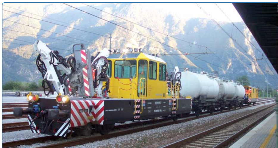
Fig. 1 - Vista frontale del treno "SALT400" per la pulizia dei tunnel
