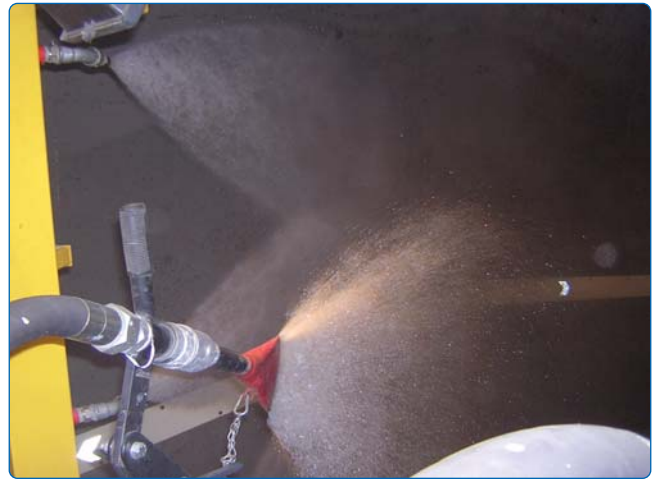
Fig. 3 - Particolare del getto di acqua in pressione per il lavaggio della segnaletica
