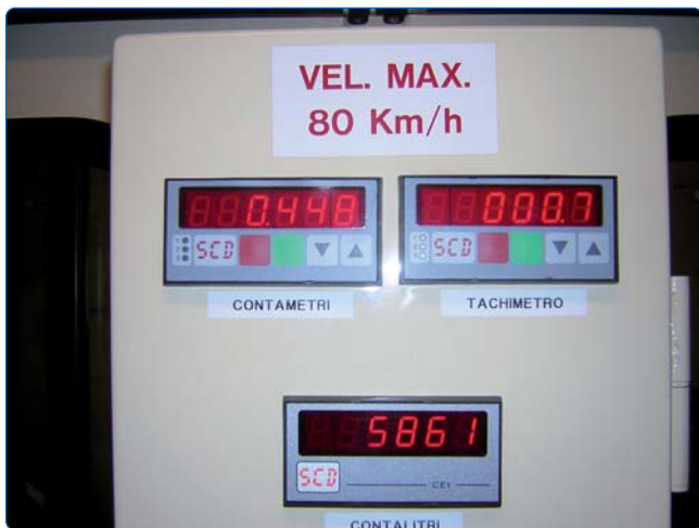
Fig. 7 - Verifica computerizzata dei consumi di acqua in funzione delle condizioni di lavoro (velocità e distanza percorsa)
