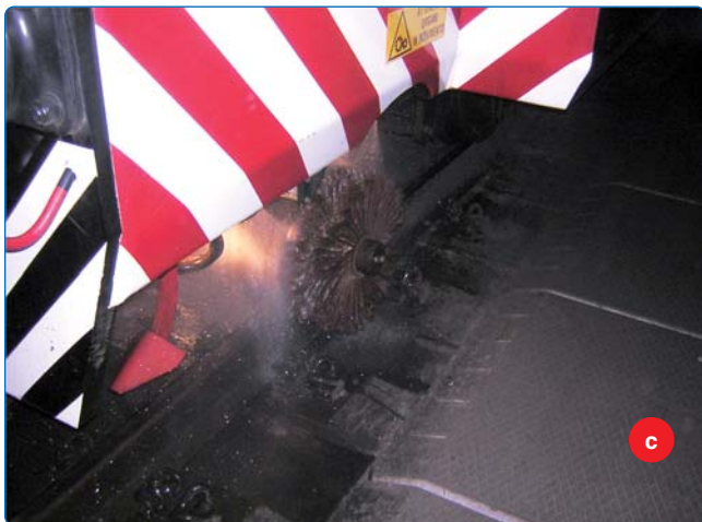
Fig. 2 - Particolari del treno pulitore per gallerie: a) spazzola per la pulizia delle pareti b) dei marciapiedi c) degli organi di attacco alla rotaia
