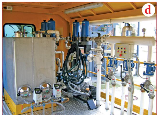
Fig. 2 - Il treno diserbatore TDC500 Evo: a) freno completo; b) fronte; c) interno cabina di guida; d) attrezzature interne
