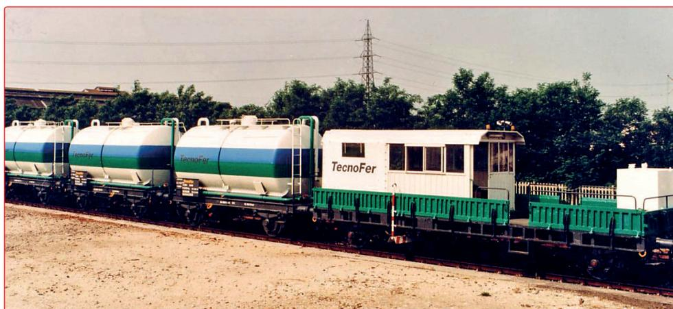
Fig. 1 - Treno diserbatore tradizionale in servizio prima del 1995, con trazione fornita da Ferrovie dello Stato
