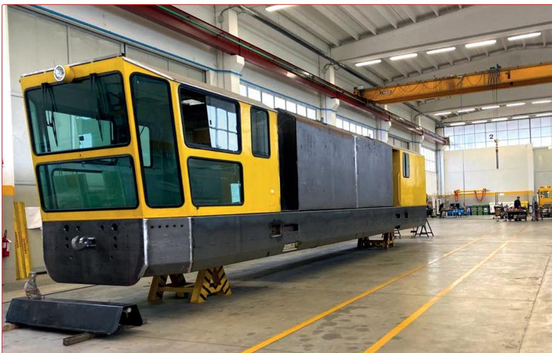
Fig. 5 - TDC 500 INTEGRATO unità pilota in fase di allestimento
